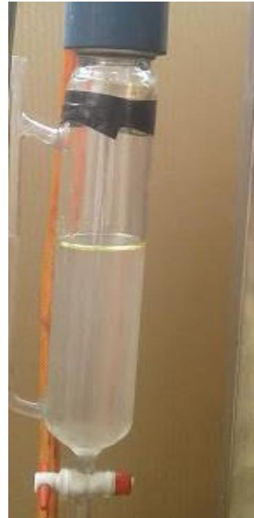
a) Equipo de destilación por arrastre de Vapor, b) Capa de aceite obtenido
