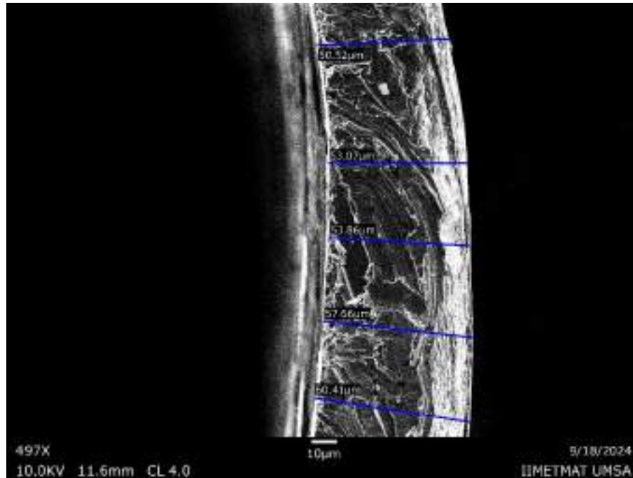
Figura 3.2 Medidas del espesor del foil de cobre laminado. Aumento 497x.
